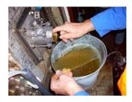
11. Une fois cristallisé, il faut séparer les cristaux durs du sirop. Pour ce faire, le sirop cristallisé passe dans une centrifugeuse qui sépare les deux. Le
