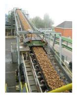
4. Les betteraves sont alors acheminées sur un tapis pour être nettoyées. Tous les métaux indésirables qui auraient pu se retrouver dans la benne lors de l'arrachage, sont attirés par un aimant géant qui va les séparer et les déposer dans une cuve spéciale.
